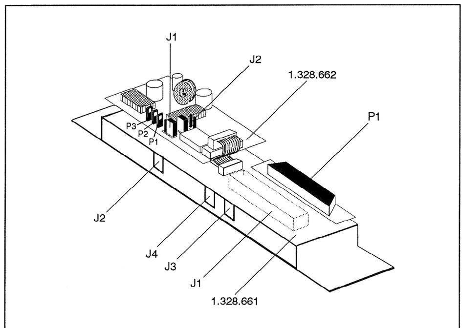
**Fig. 1** Jumper und Anschlüsse der parallelen Fernbedienung.
