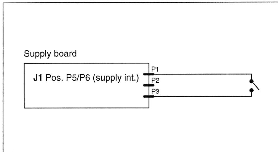
**Fig. 3** Anschluss des Faderschalters an die parallele Fernbedienung.
