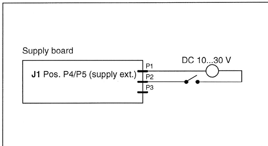
**Fig. 4** Anschluss des Faderschalters an die parallele Fernbedienung.
